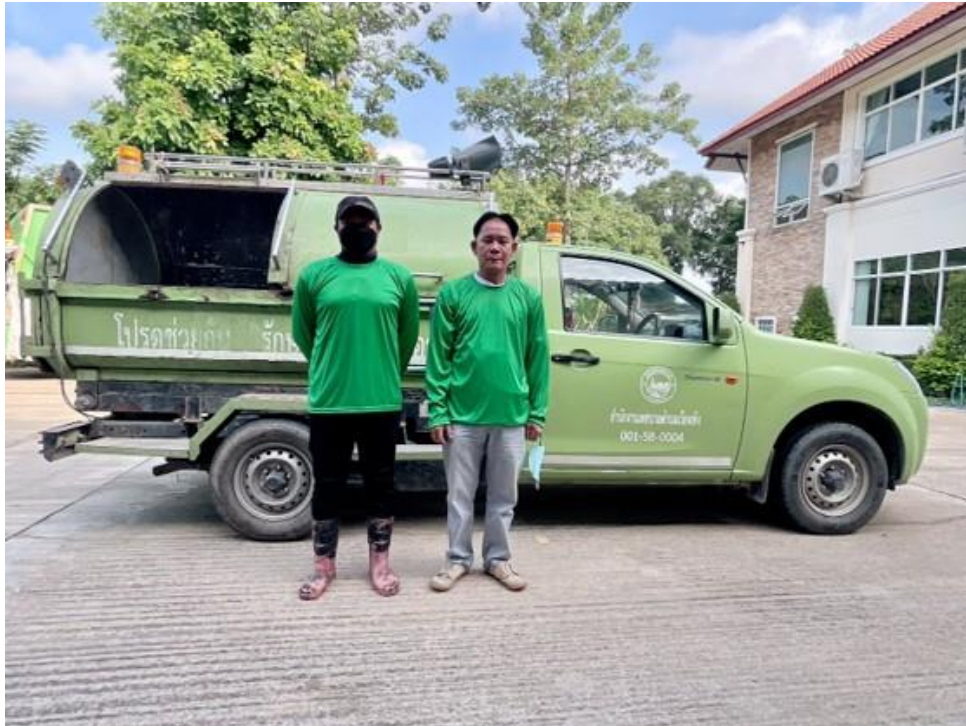
รถขยะแบบเปิดข้าง ใช้ดำเนินการเก็บขยะเปียก
